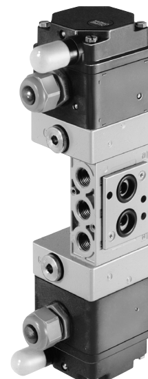
Рис. 3: 5/2-ходовой соленоидный клапан с двухсторонним управлением и двумя блокировочными положениями, K_{VS} 1,4; соединение G \frac{1}{4} , NAMUR
