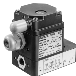
Рис. 1: 5/2-ходовой соленоидный клапан с односторонним управлением и пружинно-возвратным механизмом, K_{VS} 0,16; соединение G \frac{1}{4}
