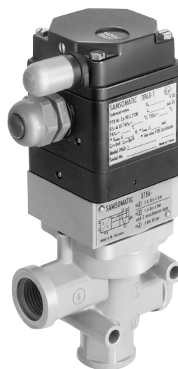
Рис. 2: 3/2-ходовой соленоидный клапан с односторонним управлением пружинно-возвратным механизмом, K_{VS} 4,3; соединение G \frac{1}{2}
