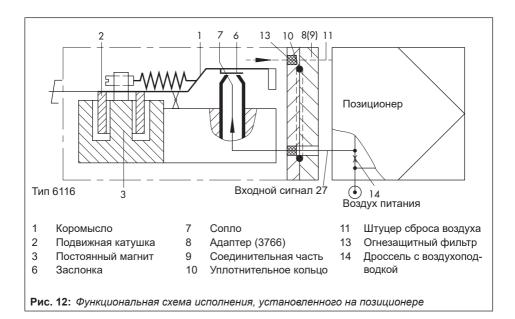
(подключение к пневматическому входному сигналу - входной сигнал 27).
